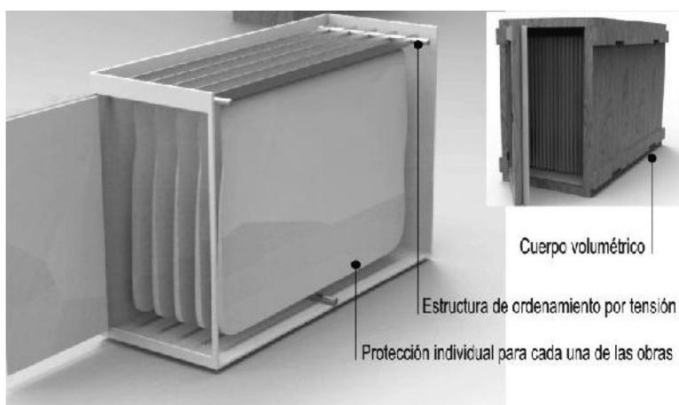
Figura 1. Configuración del módulo.
